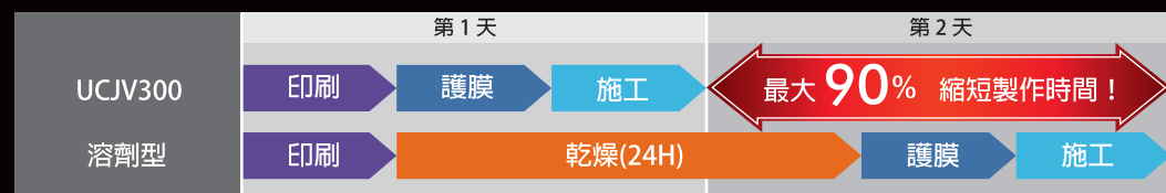
印刷後直接照射UV光，讓墨水立即固化
