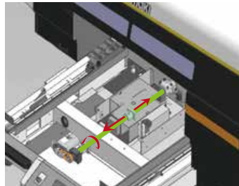
滾珠螺桿 (Ball Screw) 輸送裝置示意圖
