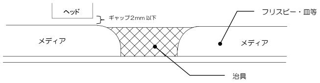
2.立体物の印刷には反射光を防ぐために吸着盤面の余白を覆ってください。 (ヘッドの移動やYバー移動の妨げにならぬようお願いします)
