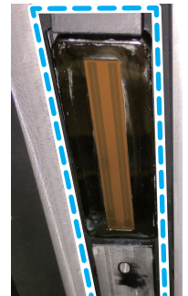
【Coating area (maintenance liquid 11)】
